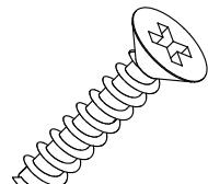
$\varnothing 3,5 \times 14 \text{ mm}$
